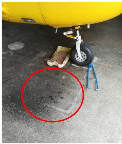
L'huile n'est pas prévue pour être mise à l'extérieur du moteur !
