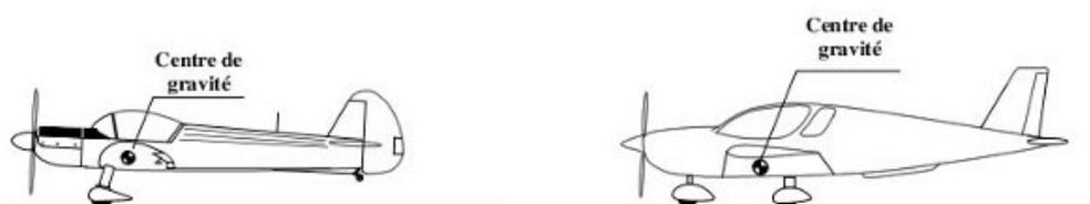
Pour le train classique, ce dernier se trouve derrière les roues du train principal qui supporte l'essentiel du poids de l'avion. A chaque changement de direction, la force centrifuge qui s'applique sur le centre de gravité a tendance à amplifier le mouvement.
