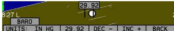
DEC- ou INC+ pour ajuster la valeur de l'altitude recherchée sur l'altimètre ou entrer la pression souhaitée. L'altitude courante est conservée lorsque l'appareil est éteint et s'affiche à l'identique lorsqu'il est remis en fonction. Le réajustement en fonction de la variation de pression est ainsi minimisé.
